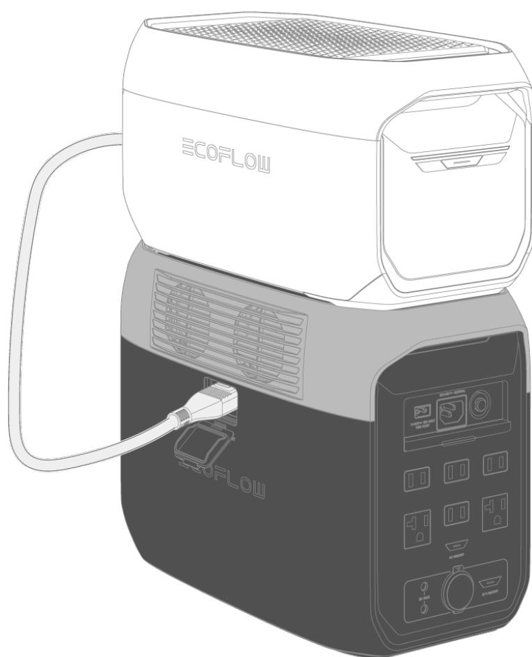
1. Подключите дополнительный аккумулятор к соответствующему разъему на электростанции.
